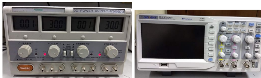
(c) Fuente de alimentación: Protomax HY3005D-3 (d) Osciloscopio: Siglent SDS 1072CML+HY3005D-3
